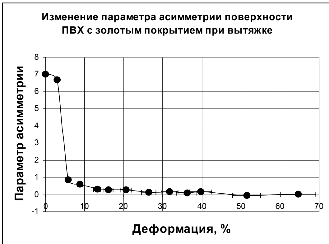
Рис. 25 Изменение параметра асимметрии для ПВХ с золотым покрытием при вытяжке
